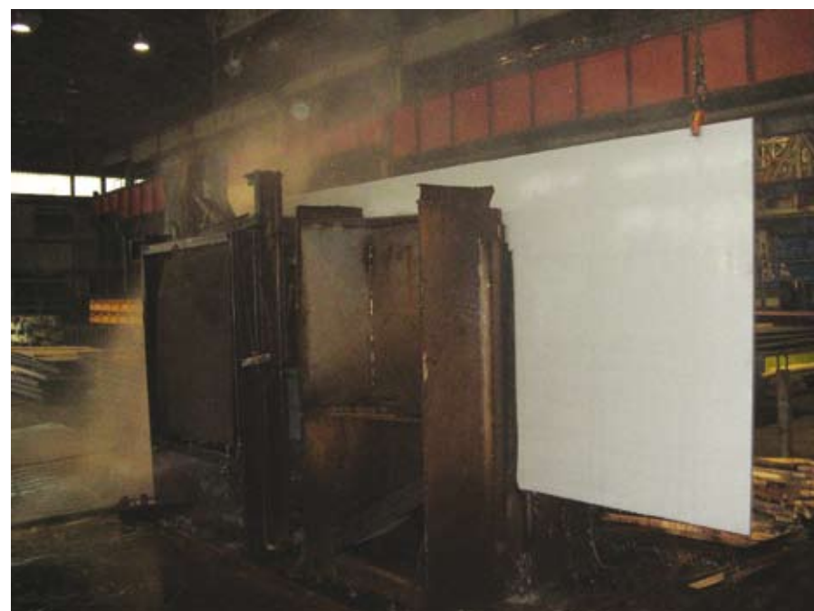
Spiralna naprava za čiščenje površine plošče po luženju
