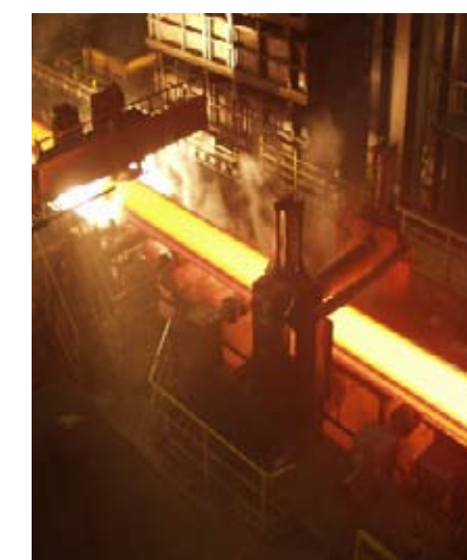
Razrez žile na kontinuirni livni napravi
