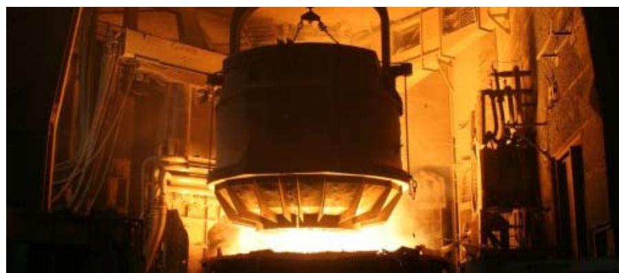
Zakladanje šaržirne košare z jeklenim odpadkom v elektroobložno peč
