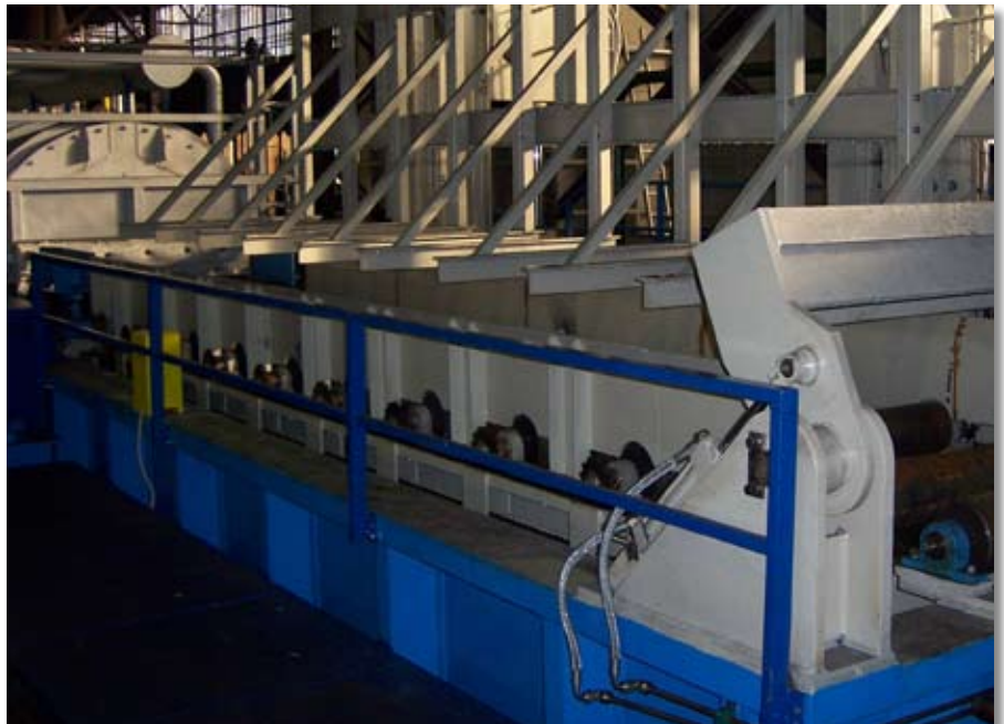
Valjana profilov: obnovljena kontinuirna peč 2 z mehanizirano in s procesno vodenom kalilno mizo
