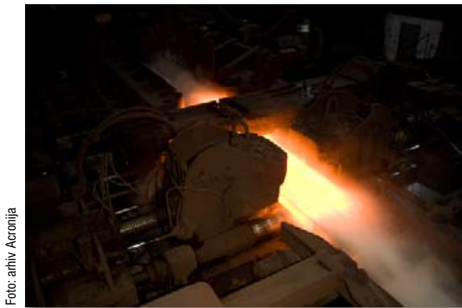
Vroče valjanje na valjavskem ogrodju "Bluming"
