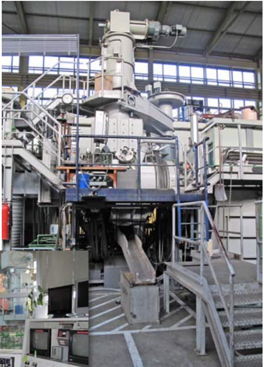
Vakuumska indukcijska peč, v kateri izdelujemo poskusne šarže, ima zmogljivost dve toni.
