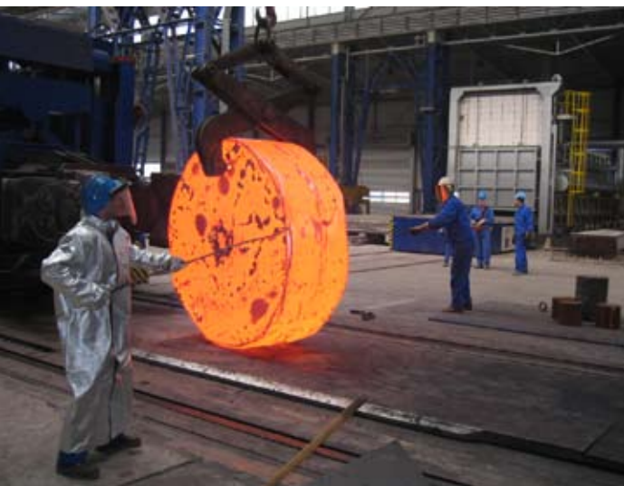
Najprej predkujemo disk iz nakrčenega ingota.
