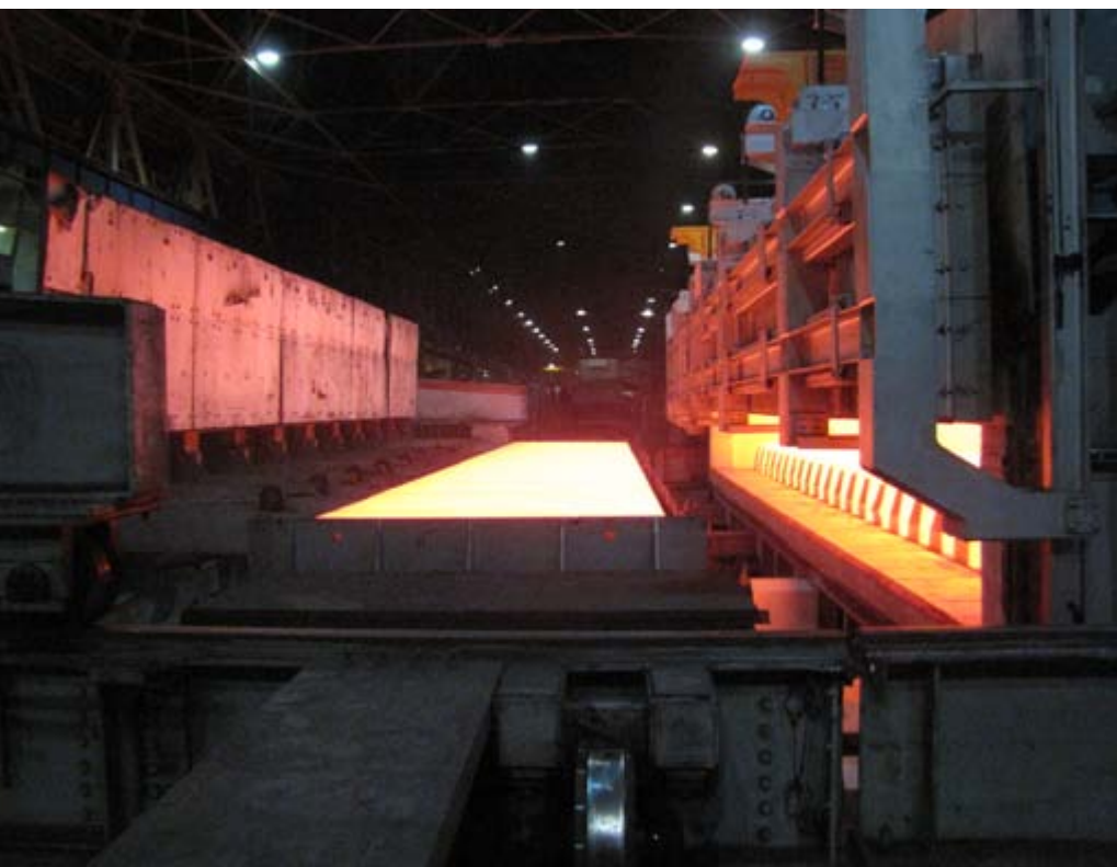
• Meritev pregretosti plošče v novi peči Bosio
