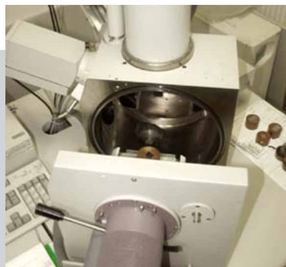
Vrstični elektronski mikroskop Philips z EDS-analizatorjem
