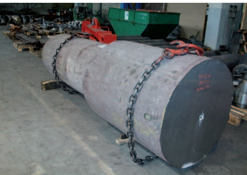
▲ Odkovek, pripravljen za mehansko obdelavo, kvalitete 34CrNiMo6 (dva odkovka v enem kosu)
