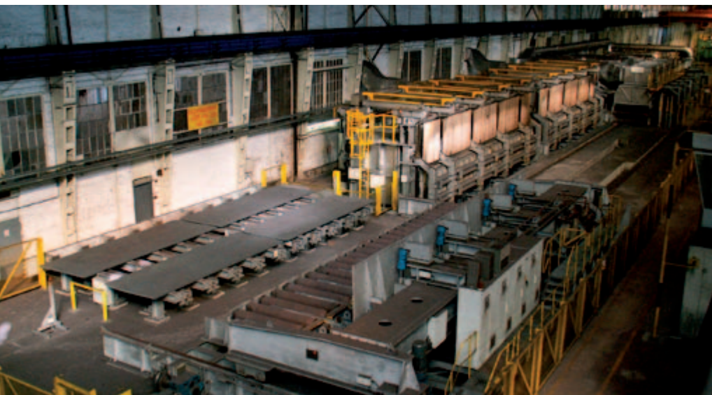
● Slika 1: Peči Wellman (desno zgoraj) in stara pripravljalna in zakladalna miza (sredina levo), kjer bo kmalu stala nova tretja peč proizvajalca Bosio
