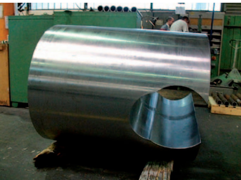
▲ Končni videz odkovka, dimenzije fi 798 mm x 1140 mm in kvalitete 34CrNiMo6
