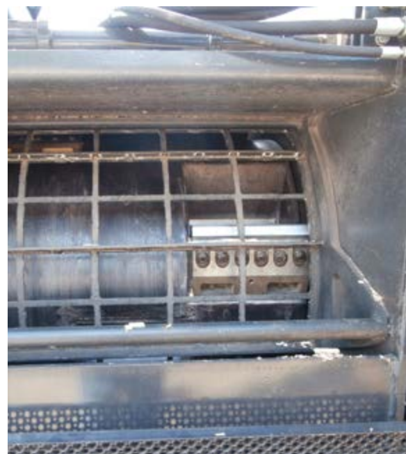
• Nož, vgrajen v stroju za mletje hlodov in izdelavo sekancev
