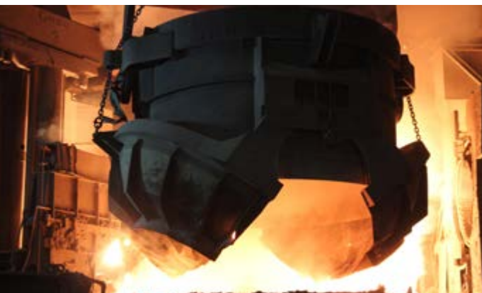
▲ Zalaganje odpadne rene v elektroobložno peč za izdelavo dupleksnega nerjavnega jekla
