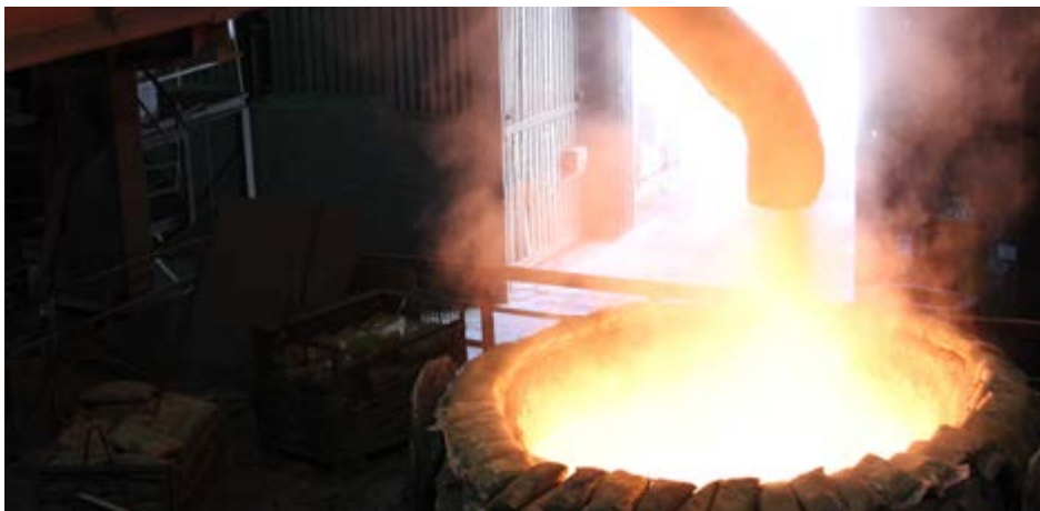
Legiranje specialnega nerjavnega jekla skupine MKM pred vakuumsko napravo
