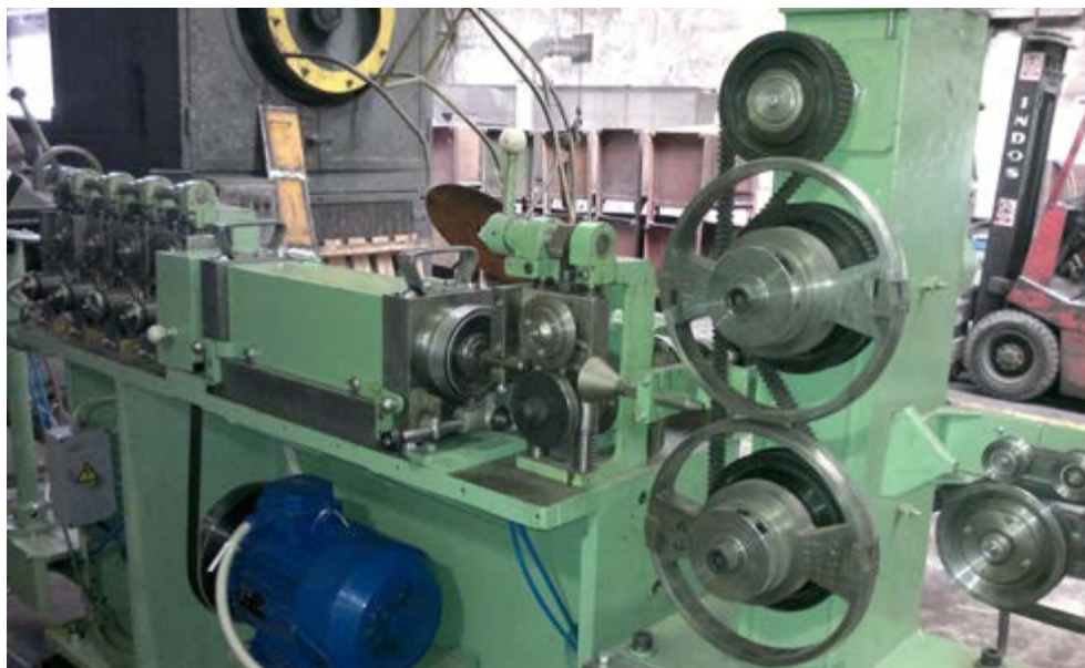
Novi sistem rezanja (leteče škarje)
