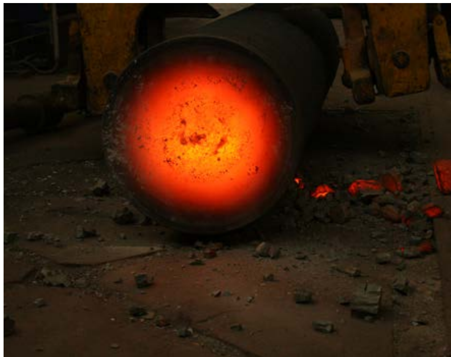
▲ Glava ingota po odstranitvi žlindrinega kolača
