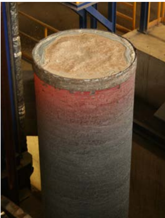
▲ Stripanje ingota, na vrhu žlindrin kolač
