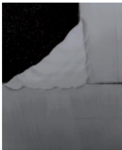
▲ Makroskopski pregled kotnega zvara na pločevinah debeline 30 mm (S355J2 + N / t = 30 mm MAG (135) / PB)
