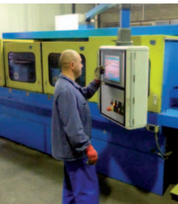
▲ Naprava za izdelavo strženske žice z laserskim varjenjem v Elektrodah
