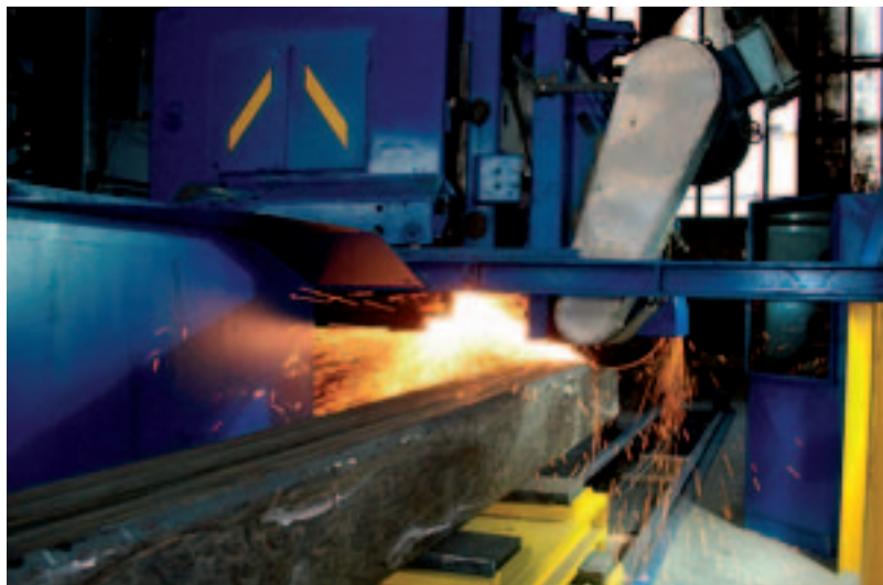
▲ Testno brušenje kovane gredice za prodajo, dimenzije 650 x 650 mm, dolžine 7 m, med prevzemanjem brusilnega stroja
