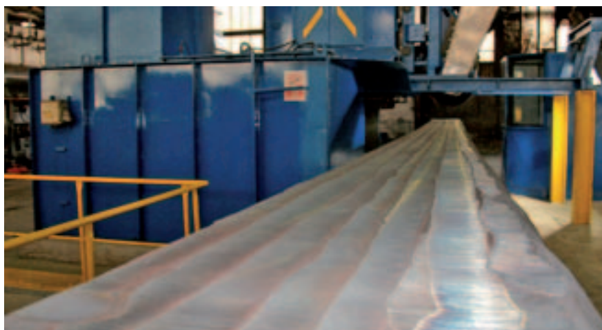
▲ Enakomerno površinsko očiščena kovana gredica na Centromaskinu 6000 v Težki kovačnici Metala Ravne, pripravljena za prodajo
