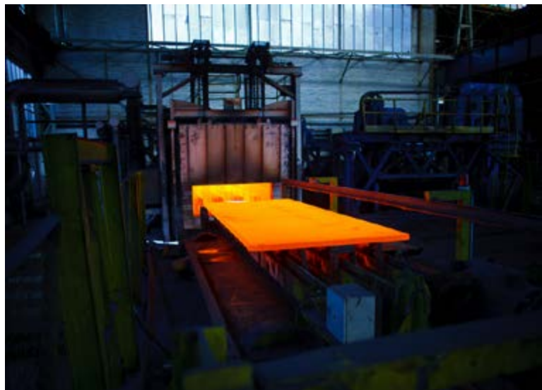
▸ Predelava plošč nerjavne debele pločevine v proizvodnji Acronija
