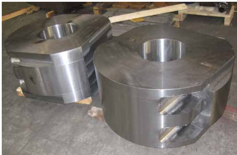
▶ Ohišja iz jekla CK22 za črpalke, kupec je iz Nemčije.
