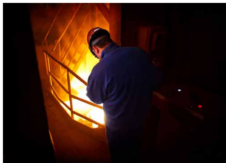
▲ Prebod taline iz elektrobločne peči v ponovco
