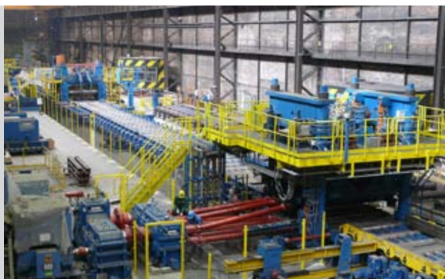
▶ Del linije z vročim ravnalnikom in s škarjami
