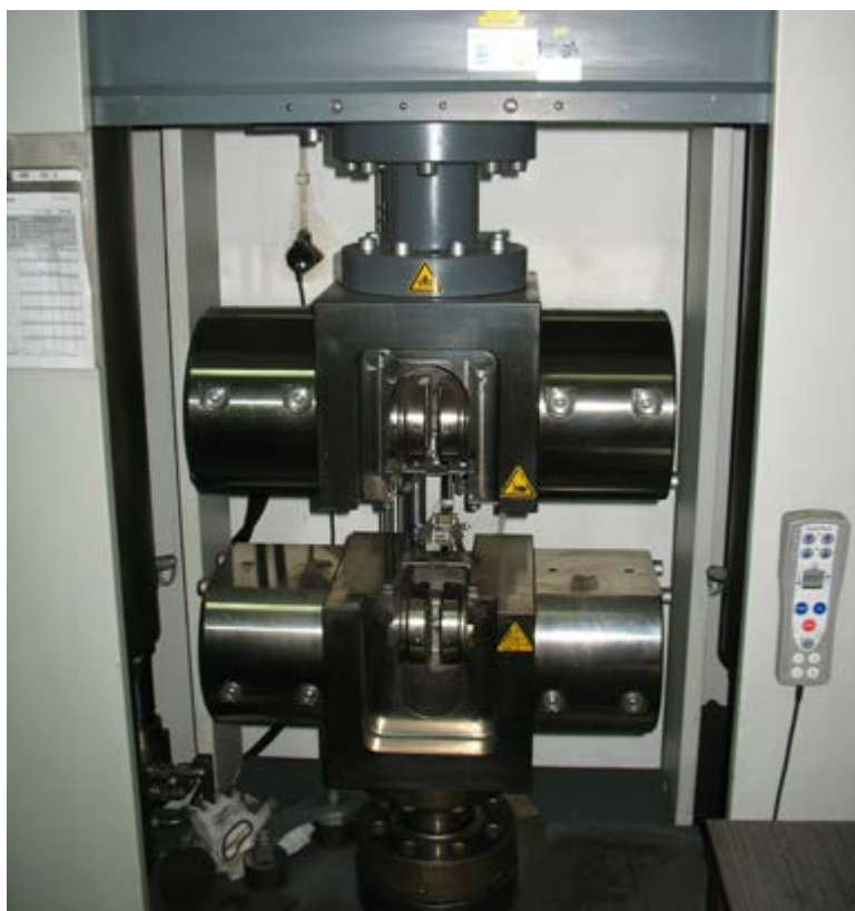
▲ Kalibrirani 600 KN trgalni stroj. Lepo se vidi vpenjalni sistem oziroma čeljusti, ki "primejo" vzorec pred raztezanjem, pri strani (levo) pa so ekstenziometri – naprave za merjenje raztezkov.
