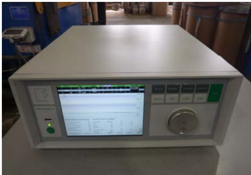
▶ Končna kontrola zaprtosti polnjene žice
