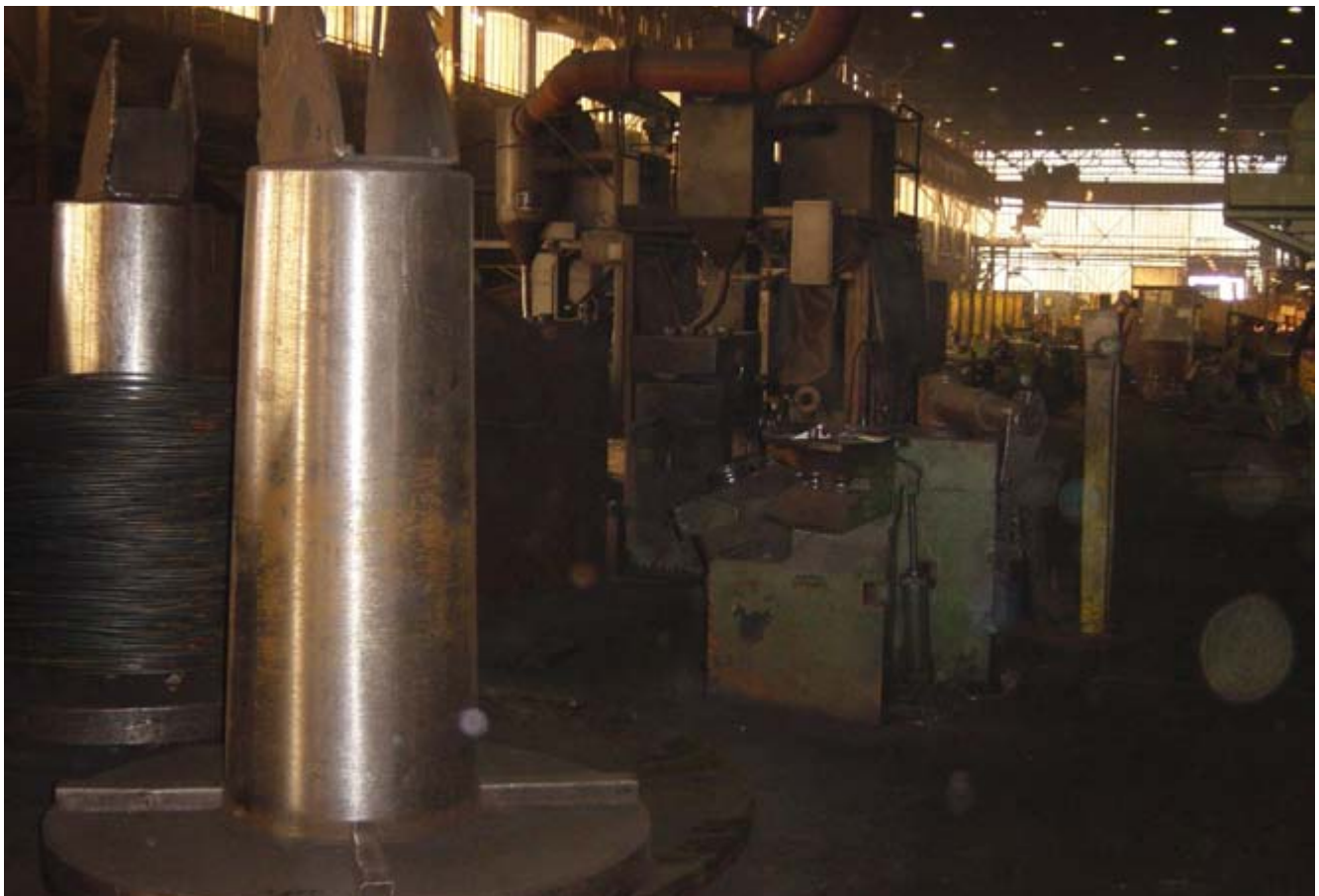
▲ Odvijalec s peskalnim strojem
