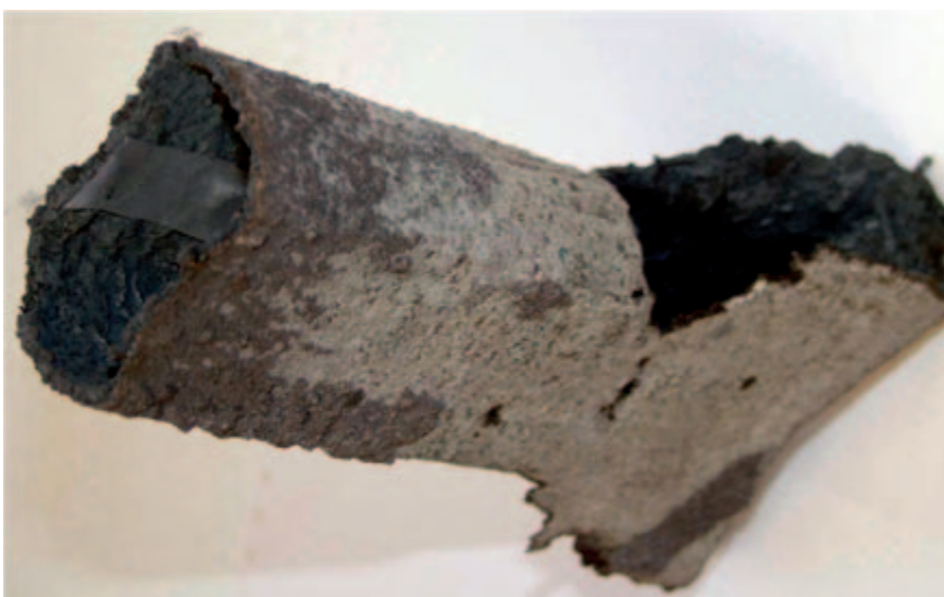
▲ Slika 2: Ostanek obloge na notranji strani potopnega izlivka po zaključku ulivanja, ki nakazuje na blago mašenje potopnega izlivka
