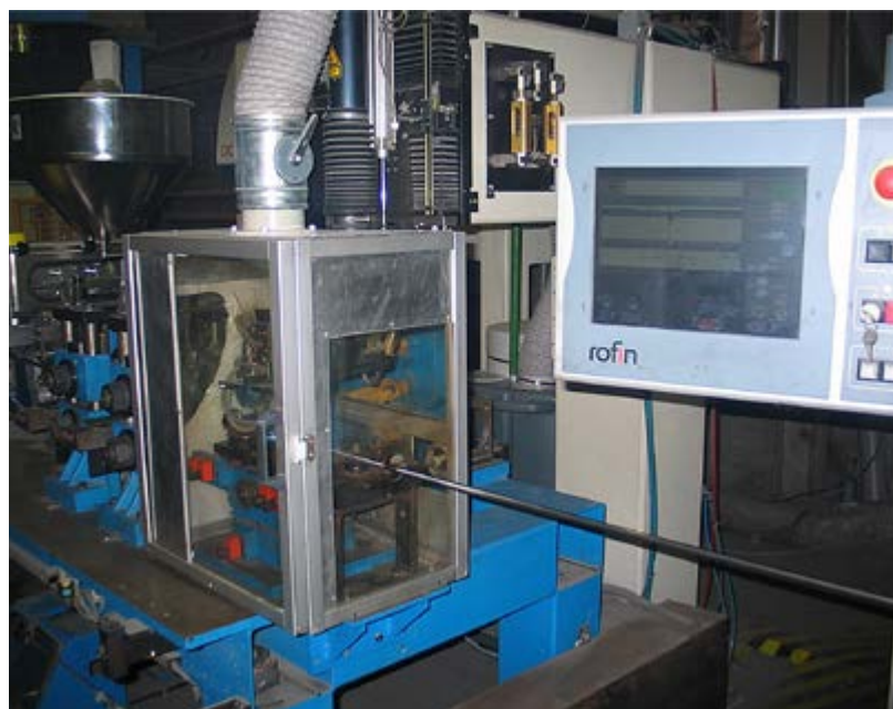
▶ Del linije, kjer se nasipa polnilo, trak dokončno formira v cev in zavari z laserjem
