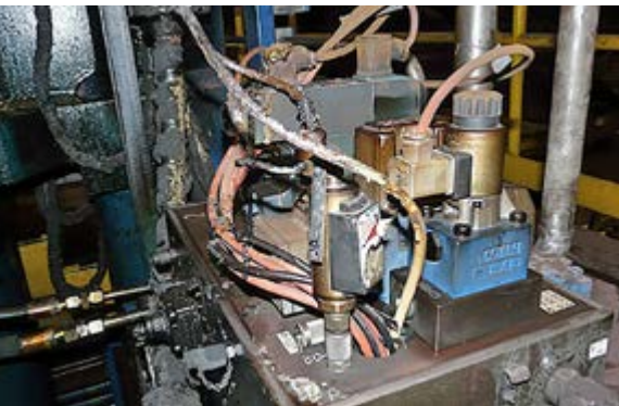
▲ Požgan visokotlačni blok s senzorji in ventili
