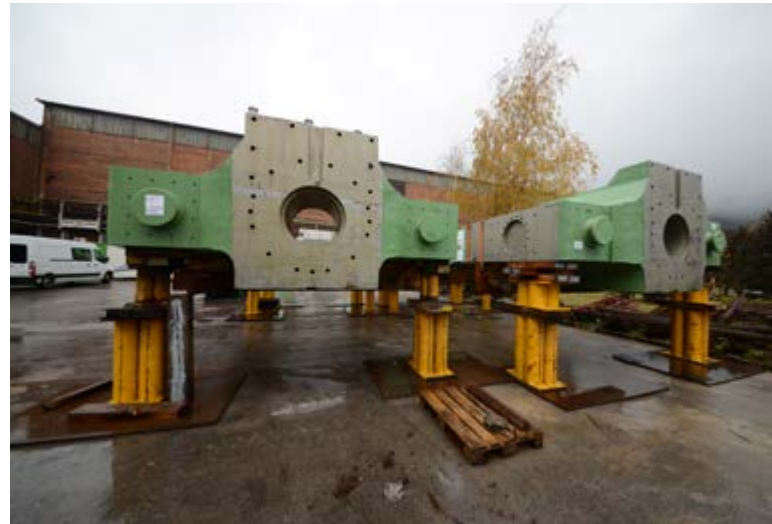
▶ Okni ogrodja čakata na vgradnjo zloženi na dvorišču Acronija.
