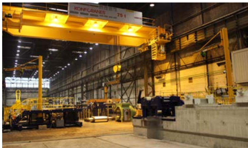
▲ Izgotovljen temelj naprave za razstavljanje valjev z vozičkom naprave in brusilnim strojem za brušenje valjev v ozadju
