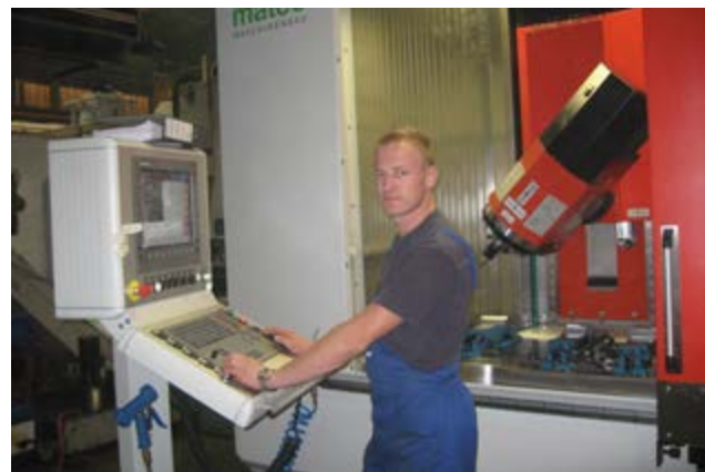
Danilo Šavc in 5-osni rezkalni stroj, ki zagotavlja lažje določevanje ravnin v prostoru
