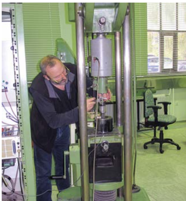
Adrijan Zalesnik pri ročnem pozicioniranju ekstenziometra na nateznem preizkušancu
