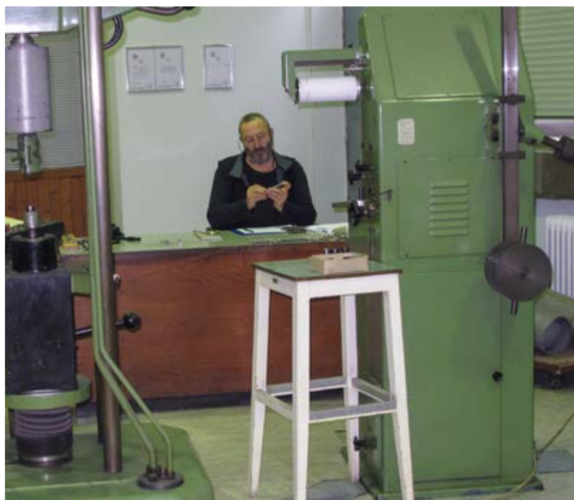
Merjenje merilne dolžine po pretrgu preizkušanca, ki bo na novem stroju izvedeno avtomatsko
