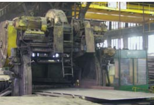
Prečni razrez plošč na liniji SACK, maj 2009
