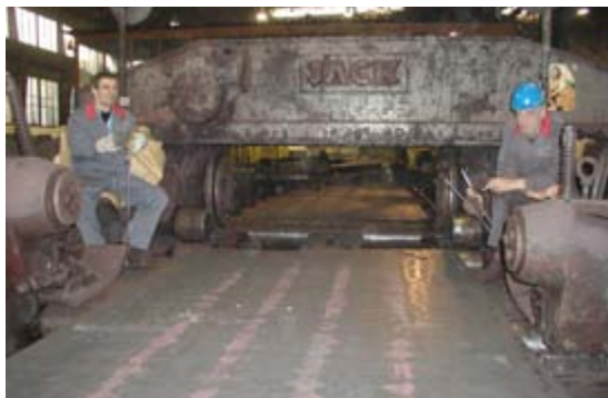
80 let stara linija SACK za stranski obrez plošč in odrezke
