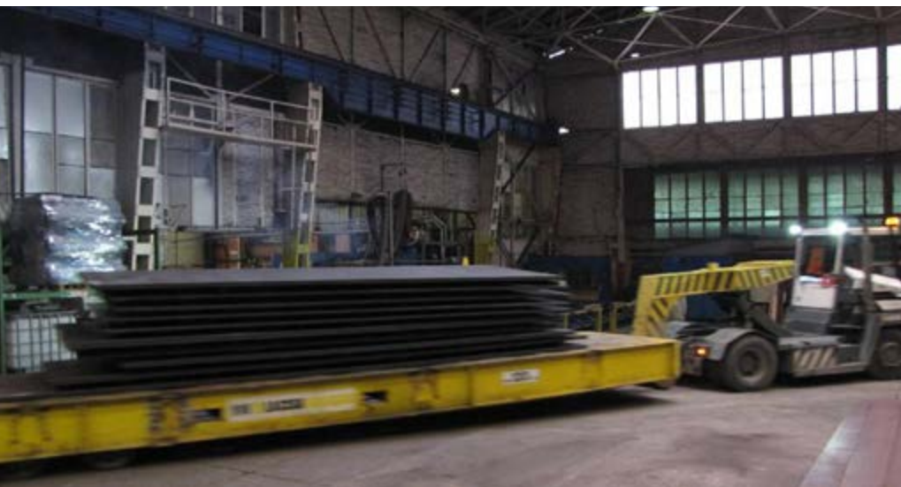
• Transport 75 ton pločevine na termično obdelavo na linijo Wellman-Bosio
