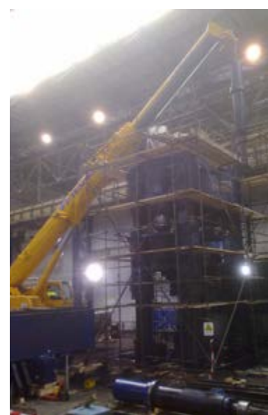
Demontaža povratnega cilindra 40/45 MN stiskalnice
