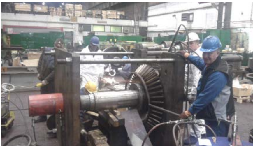
● Horizontalna stiskalnica – snemanje stožčastega zobnika
