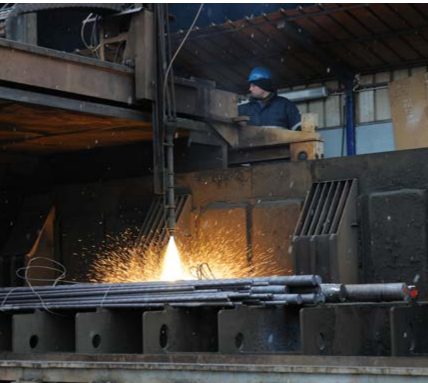
● Rezanje vložka z novo komoro je sedaj lažje.
