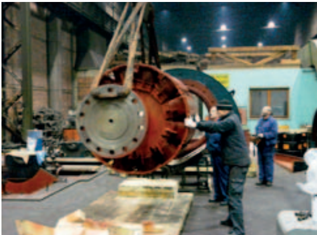
• Sestava glavnega 5600 HP pogonskega motorja generatorske skupine za ogrodje Steckel
