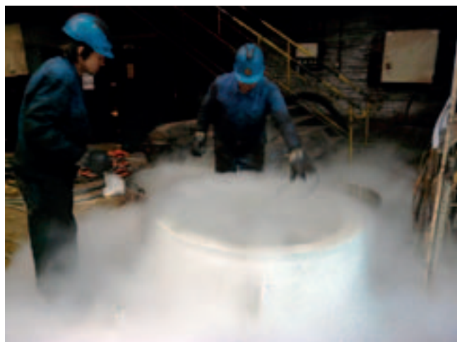
▶ Podhlajevanje puše ogrodja Edger v tekočem dušiku
