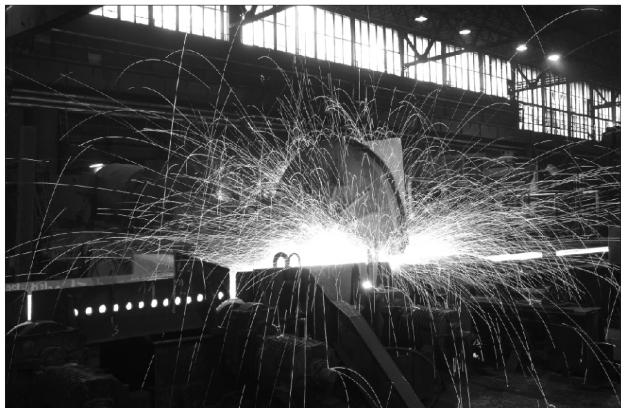
Rezanje gredice na valjarniškem ogrodju "blooming" s tornjo žago
