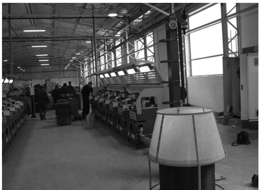
Montiranje in preskušanje nove vlečne linije za izdelavo masivnih žic
