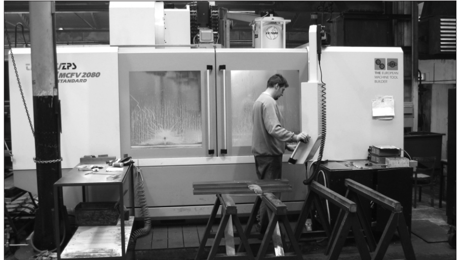
Novi CNC-rezkalni stroj ZPS MCFV 2080 – največja pridobitev proizvodnje v letu 2007
